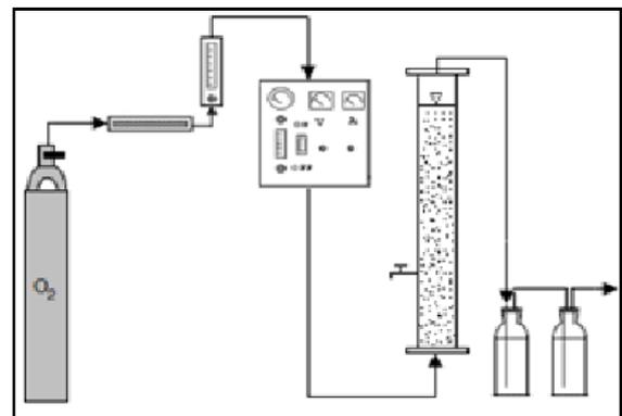
شکل ۱: راکتور ازن زنی و متعلقات آن
