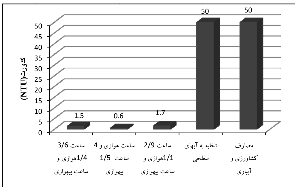
نمودار ۴: مقایسه میانگین کدورت پساب خروجی در زمان ماند های مختلف با استانداردها
