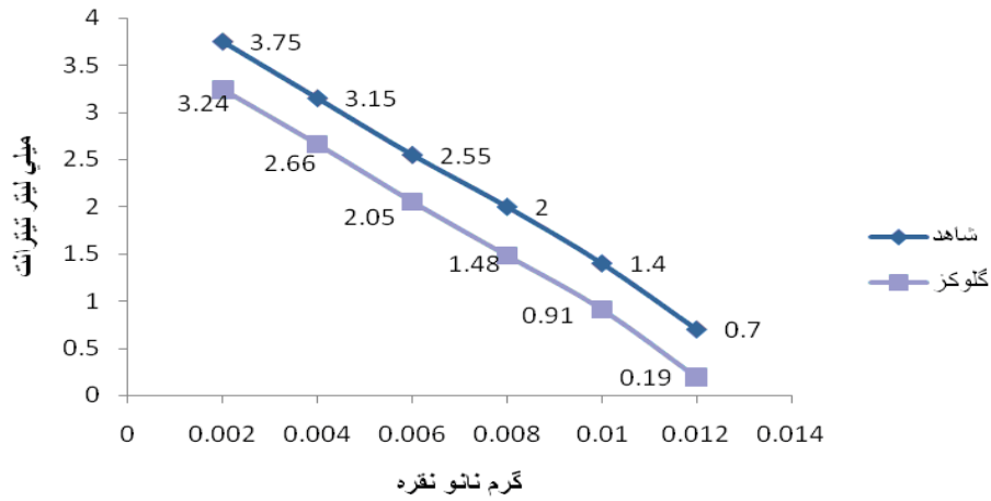
شکل ۴: نتایج بررسی تغییرات حجم تیوسولفات سدیم مصرفی در آزمون COD برحسب میزان نانوذرات نقره در هر ویال در مقایسه با نمونه شاهد (غلظت گلوکز ۵۰mg/l)
