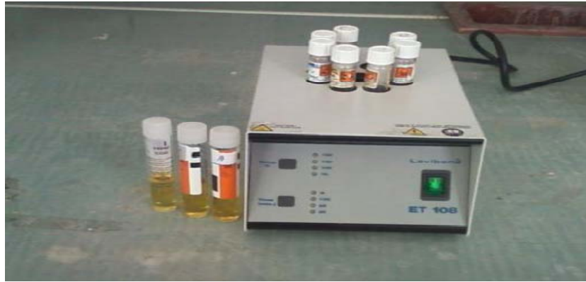
شکل ۲: نمایش تصویری سامانه های هضم برگشتی در آزمون COD الف) هضم برگشتی باز ب) هضم برگشتی بسته
