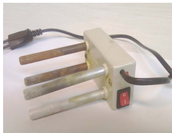
شکل ۱- اجزاء دستگاه ترسیب دهنده تجاری: ۱- الکترودهای آهن، ۲- الکترودهای آلومینیوم
